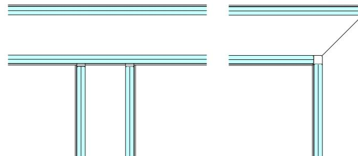
**Perfil de unión de policarbonato transparente. Conexión en "T", giros de 90º y giros variables "multi-giro"**
