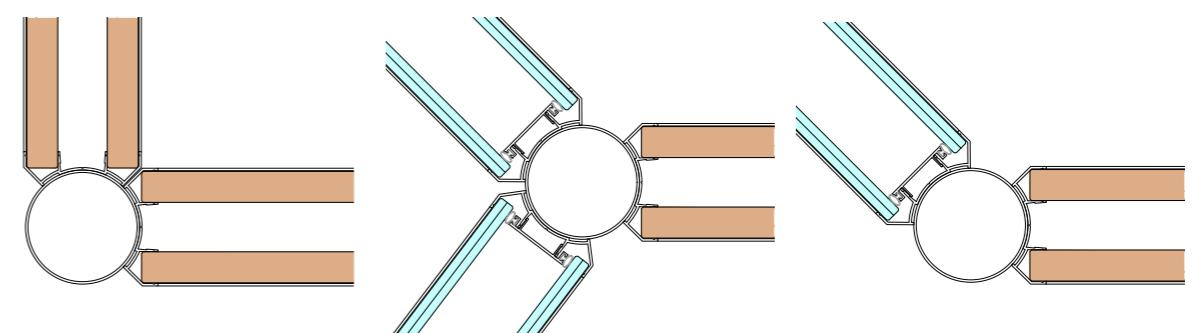
**Perfil de unión "multi-giro" de aluminio. Conexiones de dos y tres vías, entre paneles ciegos y de vidrio**
