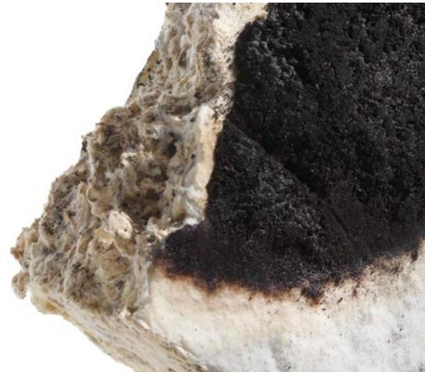
I pannelli Mogu sono naturalmente ignifughi grazie alla capacità del micelio di rallentare la propagazione delle fiamme e la formazione di carbone. Anche senza trattamento, i pannelli Mogu Acoustic carbonizzano e bruciano molto lentamente. Grazie a un trattamento ecologico, la loro reazione al fuoco è ulteriormente migliorata fino alla classe Bs2-d0\*, permettendo la loro applicazione in ogni spazio pubblico.
